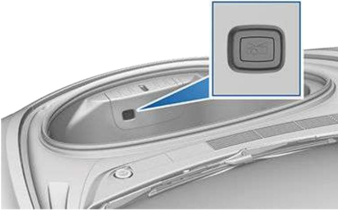
Appuyez sur le bouton de déverrouillage intérieur pour ouvrir le coffre avant puis levez le capot.
