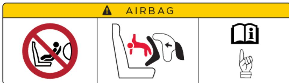
Lorsqu'un nourrisson ou un enfant est assis sur le siège passager avant (y compris lorsque l'enfant est installé à l'aide d'un dispositif de retenue ou dans un rehausseur pour enfants adéquat), vous devez désactiver l'airbag frontal passager. En cas de collision, le déploiement de l'airbag peut entraîner des blessures graves, voire mortelles, surtout si vous utilisez un dispositif de retenue pour enfants orienté vers l'arrière.
