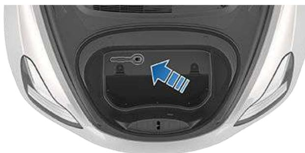
2. Retirez la protection de l'anneau de remorquage en appuyant fermement sur la zone supérieure droite de la protection jusqu'à ce qu'elle pivote, puis tirez doucement vers vous sur la section relevée.
