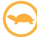
L'alimentation du véhicule est actuellement limitée car l'énergie restant dans la batterie est faible ou les systèmes du véhicule sont actuellement chauffés ou refroidis, ou une erreur est détectée par le convertisseur de puissance.
