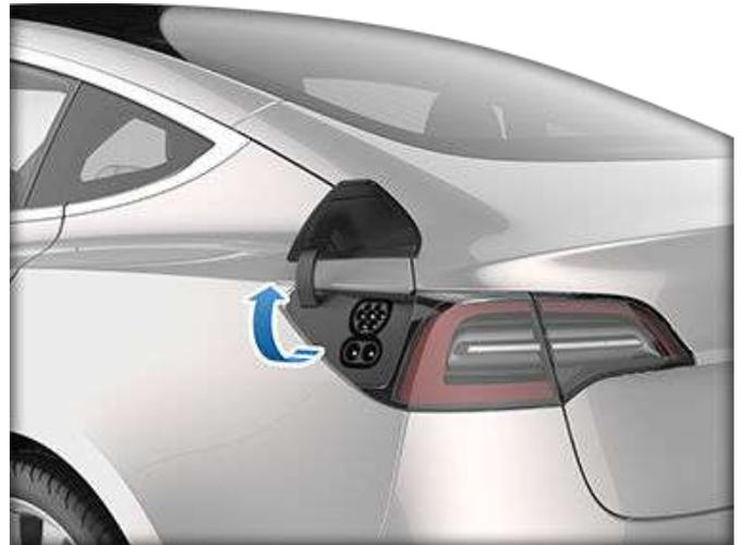
**REMARQUE :** Le « T » de Tesla devient blanc lorsque vous ouvrez la trappe de la prise de recharge. Si vous n'insérez pas de câble de recharge dans la prise de recharge quelques minutes après avoir ouvert la trappe de la prise de recharge, la trappe de la prise de recharge se ferme. Dans ce cas, utilisez l'écran tactile pour ouvrir à nouveau la trappe de la prise de recharge.
