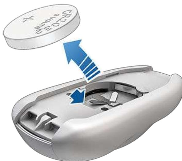
3. En évitant de toucher les surfaces planes de la pile, insérez la pile neuve (type CR2032), côté « + » orienté vers le haut.
