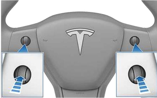
3. Au bout de quelques secondes, le logo Tesla apparaît. Attendez environ 30 secondes que l'écran tactile redémarre. Si l'écran tactile ne répond toujours pas ou si son comportement reste inhabituel au bout de quelques minutes, essayez de mettre le véhicule hors tension, puis de nouveau sous tension. Voir [Mise hors tension, puis sous tension du véhicule on page 55](#).
