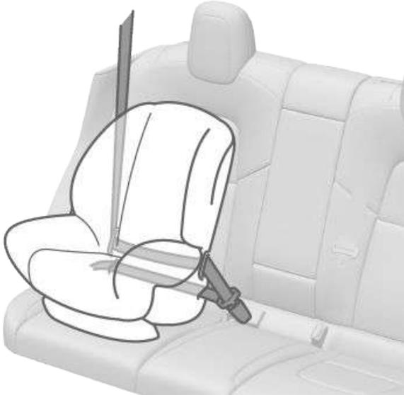
2. Laissez la ceinture de sécurité s'enrouler, puis faites en sorte qu'il n'y ait pas de jeu avec la ceinture de sécurité tout en poussant fermement le dispositif de retenue pour enfants dans le siège du véhicule.
