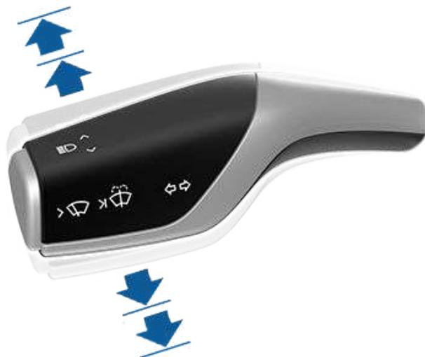
Les clignotants cessent de fonctionner lorsque vous les annulez via le volant, en déplaçant le levier dans la direction opposée ou en appuyant légèrement sur le levier une nouvelle fois dans la même direction.
