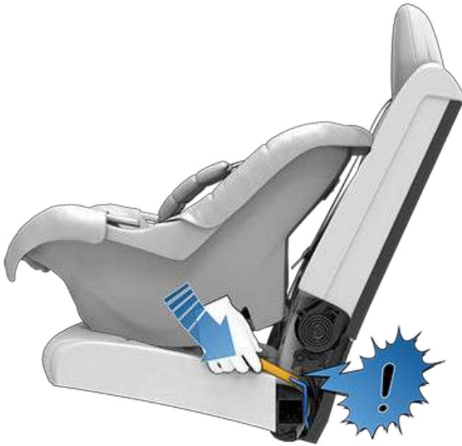
Avant d'installer l'enfant, assurez-vous que le dispositif de retenue est solidement fixé. Saisissez la partie avant du dispositif de retenue en le tenant d'une main de chaque côté et essayez de :
