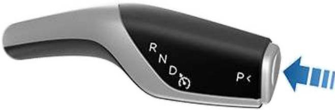
**REMARQUE :** Le frein de parking fonctionne uniquement sur les roues arrière et est indépendant du système de freinage à pédale.
