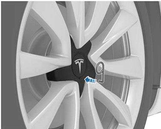
2. Utilisez l'outil du cache d'écrou de roue afin qu'il soit entièrement inséré dans le trou du cache d'écrou de roue.
