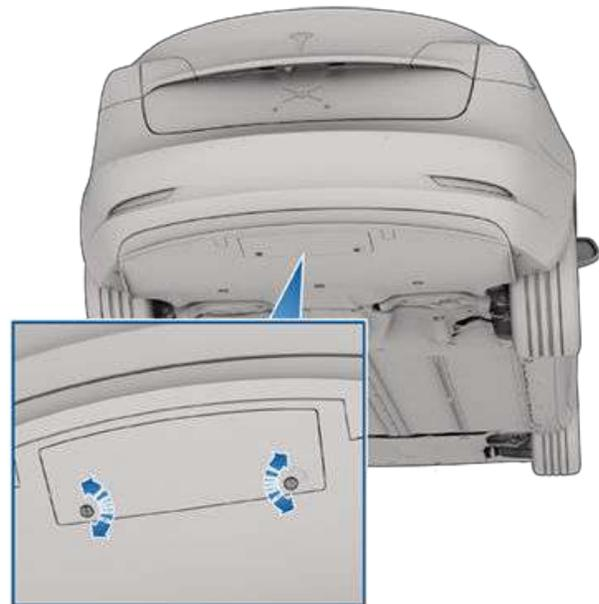
2. Insérez la clé dans le système de verrouillage du dispositif d'attelage et tournez le cylindre de façon à ce que la partie supérieure de la clé soit alignée sur la position « ouverte ».
