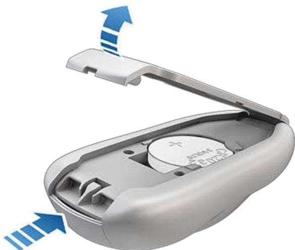
2. Retirez la pile en l'extrayant des clips de retenue.
